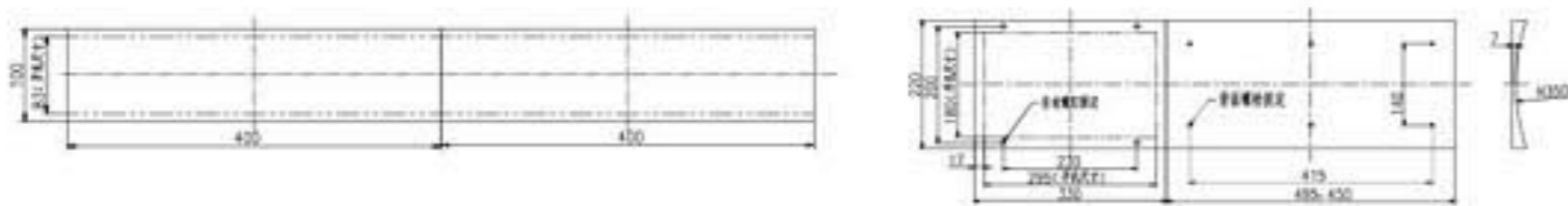
FY400B 出风口 FY400B wind outlet FY400B 过渡板 FY400B transition board FY330F 型出风口(门片式) FY330F wind outlet FY330F 过渡板(凹面) (长度分为495、450) FY330F transition board (concave) (495, 450)
